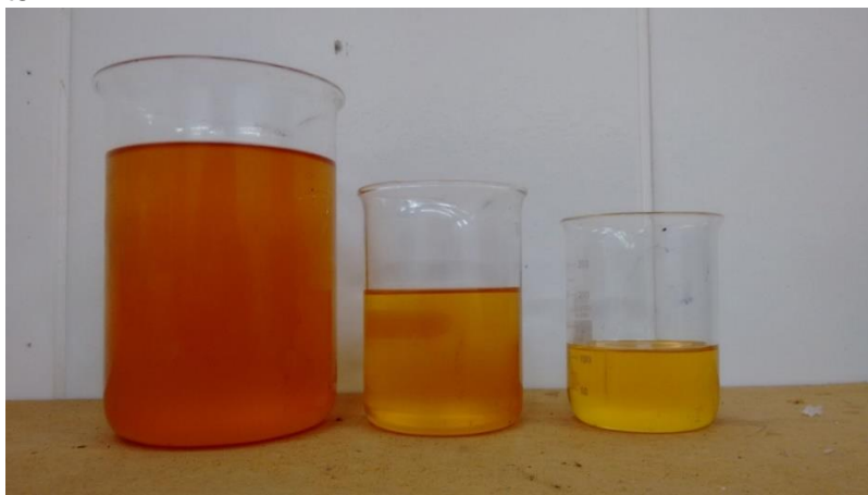
Figura 1 – Aspecto do óleo residual de fritura, óleo filtrado com papel de filtro e pano de prato, respectivamente.
