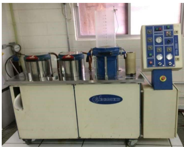
FIGURA 7- EQUIPAMENTO FORMADOR DE FOLHAS EM LABORATÓRIO.
