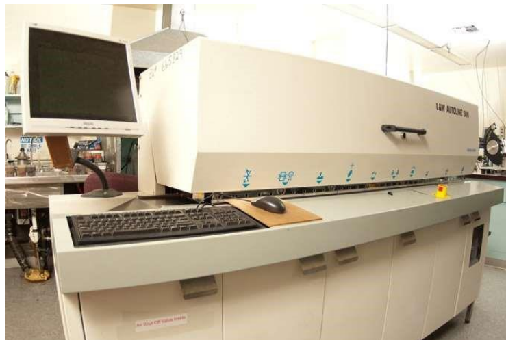
FIGURA 8 - EQUIPAMENTO AUTOLINE (L&W) 300 QUE REALIZA OS TESTES EM LABORATÓRIO.
