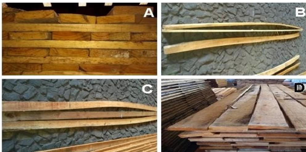
FIGURA 6 – Exemplo de defeitos observados após secagem.
