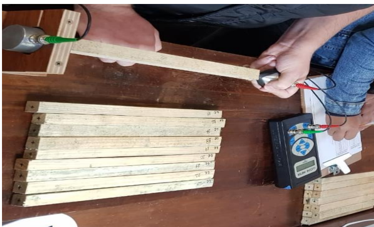
FIGURA 2 - Teste de propagação de velocidade de onda ultrassônica.
