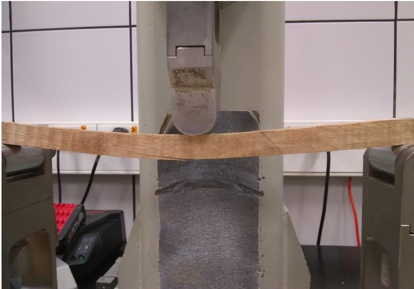
FIGURA 9 – Corpo de prova recebendo a força aplicada.
