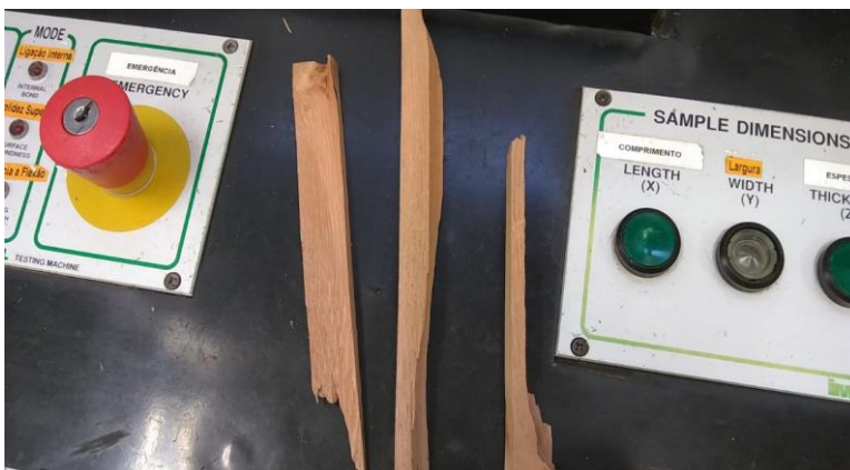
FIGURA 10 – Ruptura do corpo de prova.
